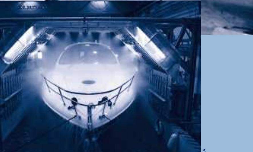
1 Impianto di gelcattura automatico e robotizzato.
